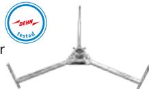
Anpassung an die Dachneigung bis max. 10° möglich. Anschluss mit Doppelüberleger für 2x Rd 8-10 mm [Blitzstromtragfähigkeit 100 kA (10/350 µs)]. Der stapelbare Betonsockel (Art.-Nr. 102 010) und die Unterlegplatte (Art.-Nr. 102 050) sind separat zu bestellen.
